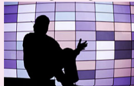
aberration géométrique (barillet)
