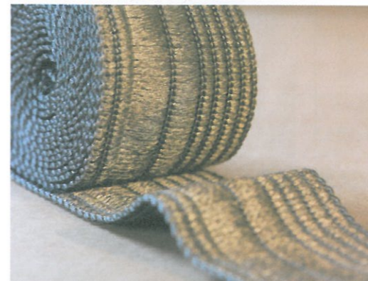
Produit réalisé 100% à partir de matériaux en alliage d'acier inoxydable qui trouve son utilité notamment dans la formation des vitrages automobiles
